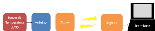
Figura 1. Diagrama de blocos do sistema de controle de temperatura em bombas d'água.
