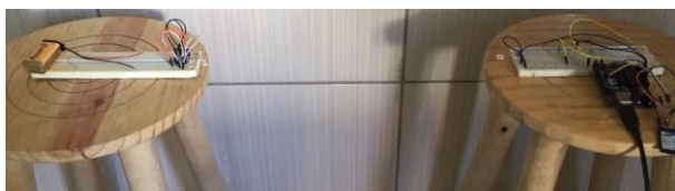
Figura 1 – Sistema de Medição de Chuva mostrando o transmissor (a esquerda) e o receptor (direita). Fonte: os autores.
